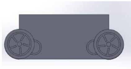
Figura 6. Vista lateral del robot sembrador, en posición de altura mínima. Fuente: Elaboración propia.
