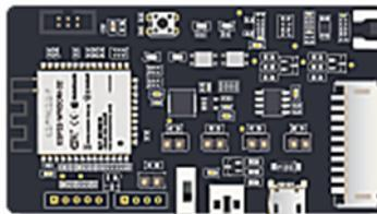
**Figura 1.** ESP32, microcontrolador a 32 Bits (Fuente: [www.esspresif.com](http://www.esspresif.com))
