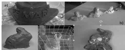
*Figura 4.- a-b) Pieza de chocolatería a partir del molde de silicon de grado alimenticio impresión en 3 D y c 1-3) Elaboración de pieza de cera para aplicar el método de cera perdida y obtener una pieza de metal para el curso de moldeo y fundición respectivamente.*
