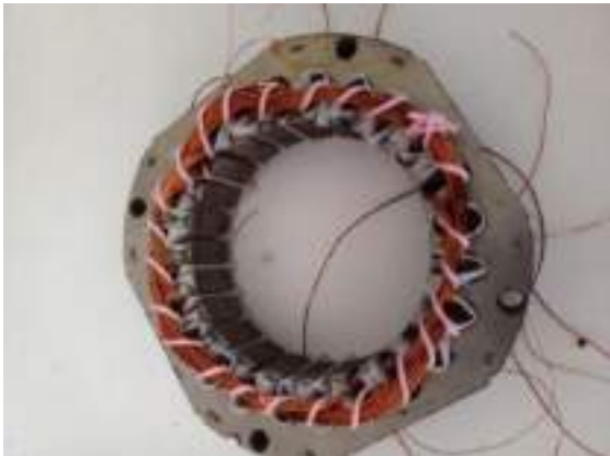
Figura 12. Se observa el amarre del bobinado. Fuente: Elaboración propia
