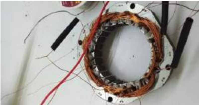
Figura 7. Bobinado de trabajo en el motor de práctica. Fuente: Elaboración propia
