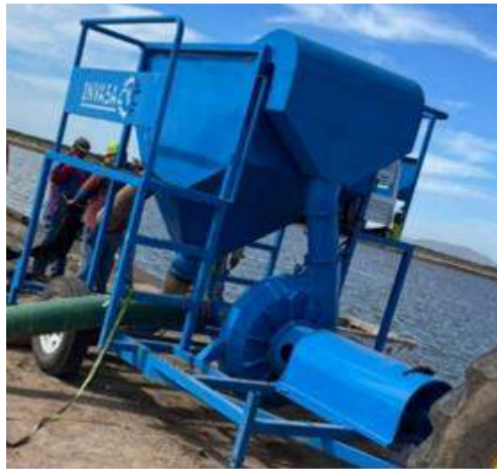
Figura 2. Cosechadora de camarones de INVASA CNC.
