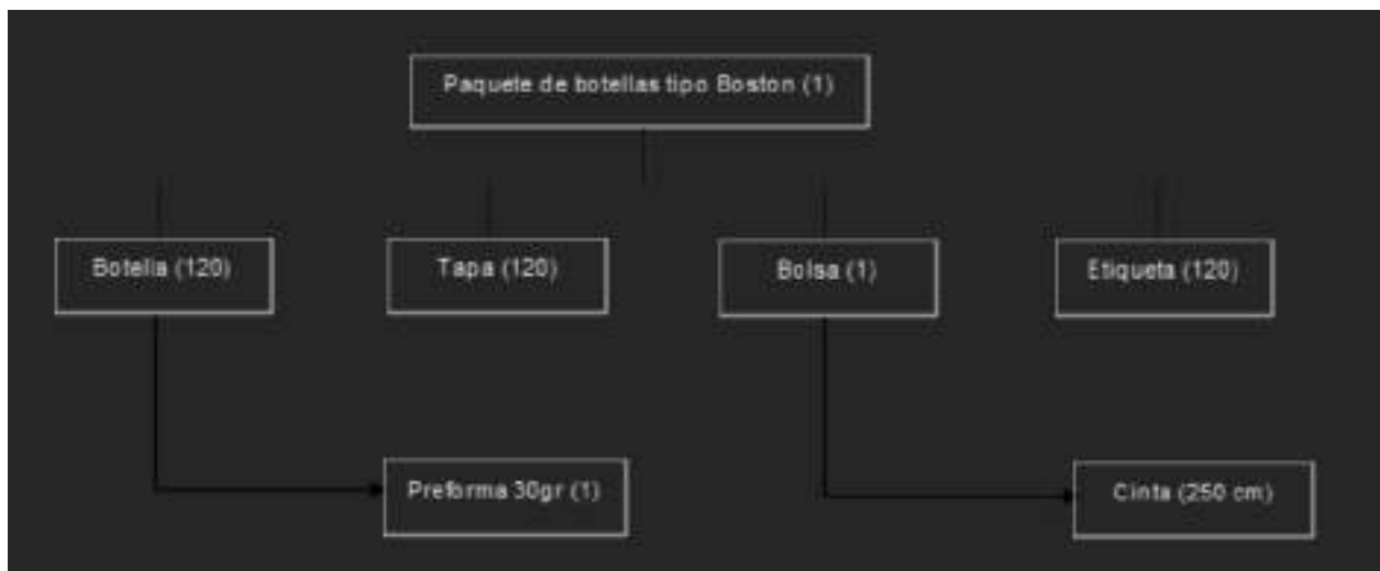
Figura 2 Bom de materiales para la botella tipo Bostón de 1000 ml.
