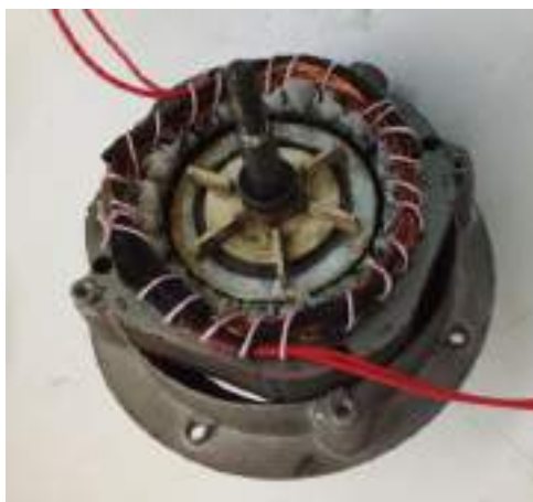
Figura 13. Se observa el bobinado al cual ya se le realizaron las conexiones.
