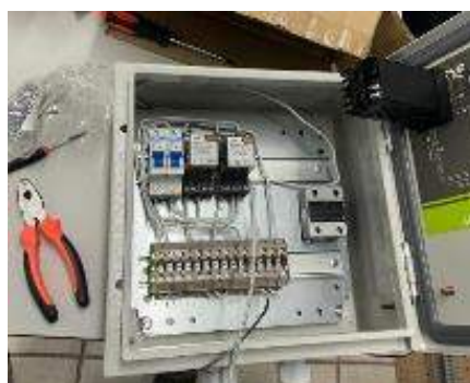
Figura 4. Implementación del circuito
