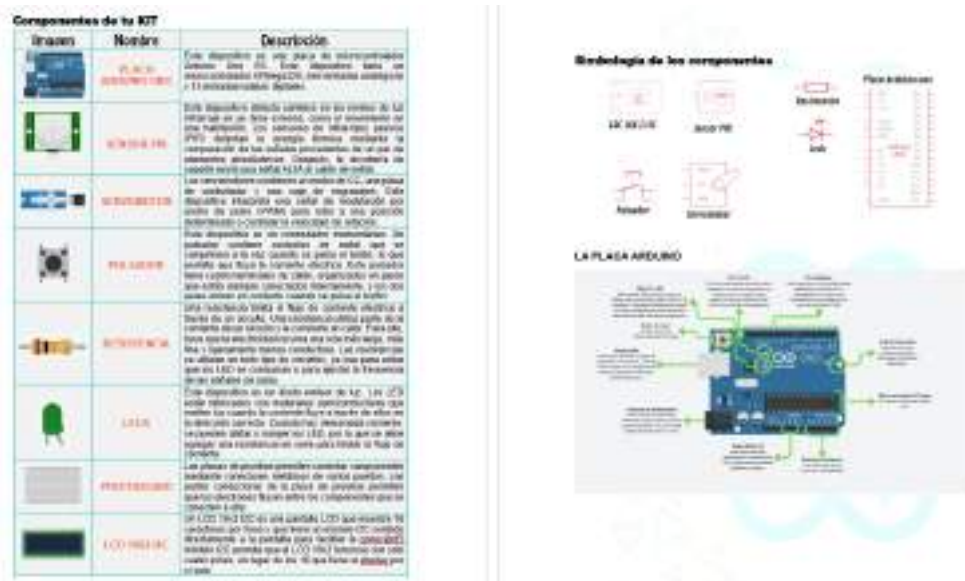
Figura 3: Tabla de componentes electrónicos con sus características técnicas y simbología Fuente: Elaboración propia
