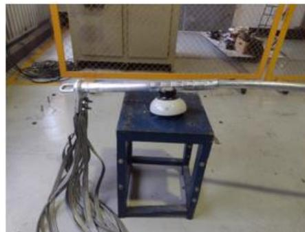
Figura 7. Muestra A de cable de alta temperatura calibre 1020 durante su aplicación de corriente.
