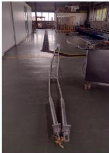
Figura 2. Cables ACCC compuesto de fibras de carbono.
