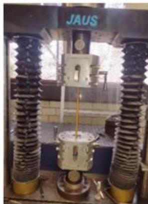
Figura 16. Acondicionamiento para realizar ensayo de resistencia a la ruptura del núcleo.
