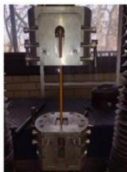
Figura 15. Acondicionamiento para realizar ensayo de resistencia a la ruptura del núcleo (zona alejada de falla).
