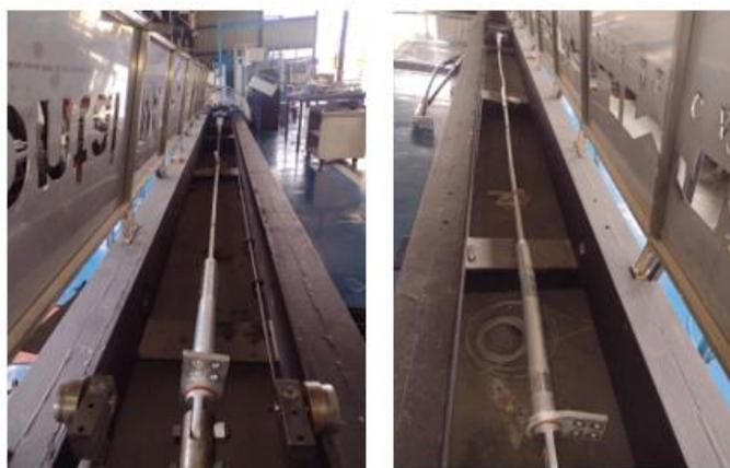
Figura 9. Ensayo de tensión a cable de alta temperatura calibre 1020 cortes A y B.
