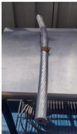
Figura 3. Cable ACCC seccionado 1020 denominado Drake TW.
