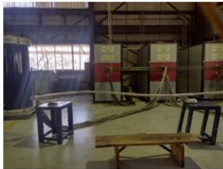
Figura 6. Arreglo del circuito para aplicar la corriente al conductor de alta temperatura.
