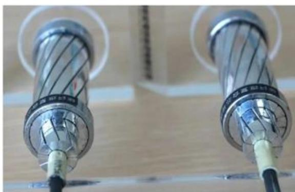
Figura 1. Perspectiva del cable de alta temperatura ACCC.
