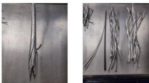
Figura 12. Muestra A del conductor donde se aprecia tinte marrón.
