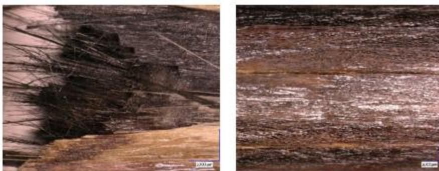
Figura 18. Análisis microscópico de una muestra posterior al acondicionamiento del núcleo que compone el cable de alta temperatura.
