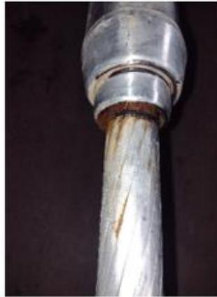
**Figura 8. Muestra B de cable de alta temperatura previo a su acondicionamiento en la prueba de resistencia a la tensión.**
