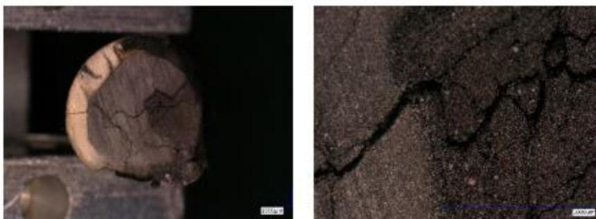
Figura 19. Análisis microscópico de una muestra posterior al acondicionamiento de la sección transversal del núcleo
